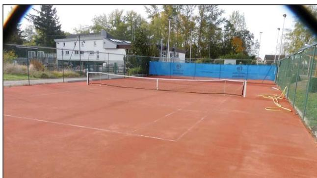
Les 2 terrains de tennis ont également été complètement relookés avec un procédé de terre battue synthétique composé d'un textile aiguilleté et de brique pilée. Un nouveau type d'éclairage Led a également été installé.
